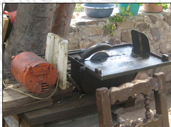
Cortadora para quitar las impurezas del Ágatas de Fuego.
