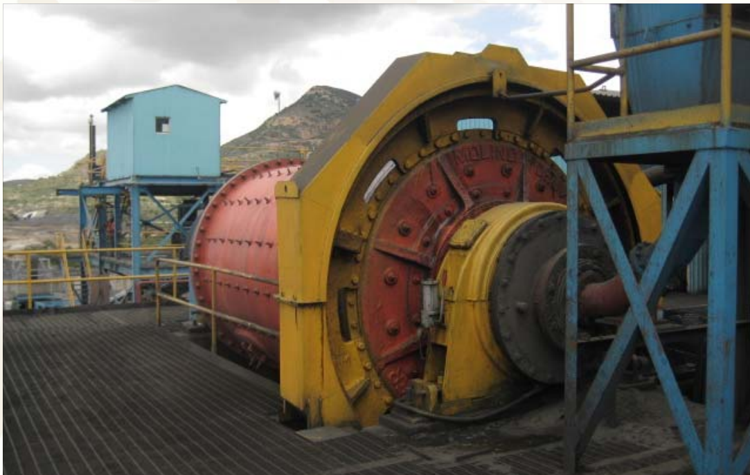
Molino "SAG-Semiautógeno " de la planta Santa Francisca
