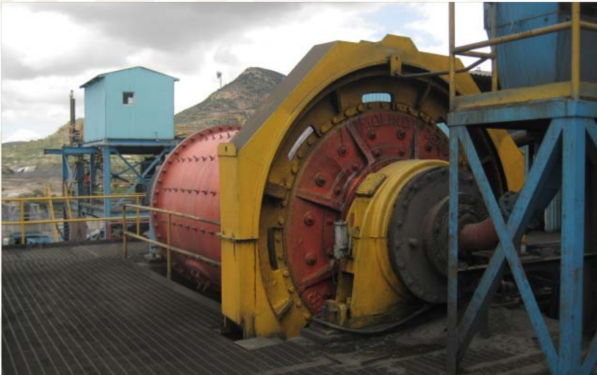
Molino "SAG-Semiautógeno " de la planta Santa Francisca
