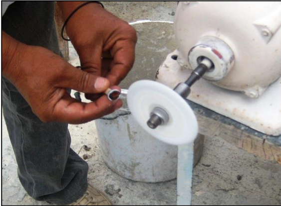
Pulidora de Ágatas de Fuego, utilizando óxido de estaño.
