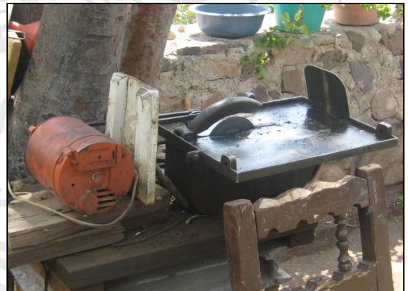
Cortadora para quitar las impurezas del Ágatas de Fuego.
