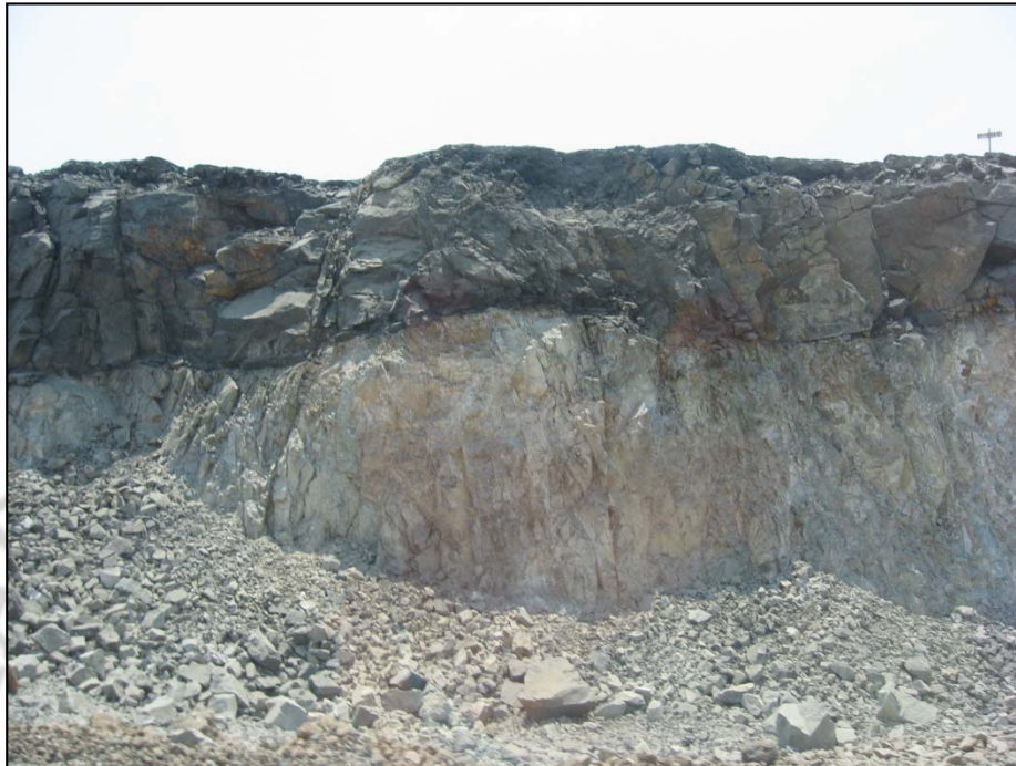
Uno de los mantos de hierro en explotación, con 6 m de espesor aproximadamente.
