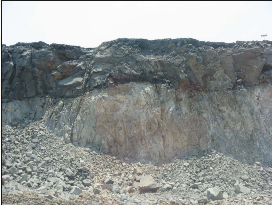
Uno de los mantos de fierro en explotación, con 6 m de espesor aproximadamente.
