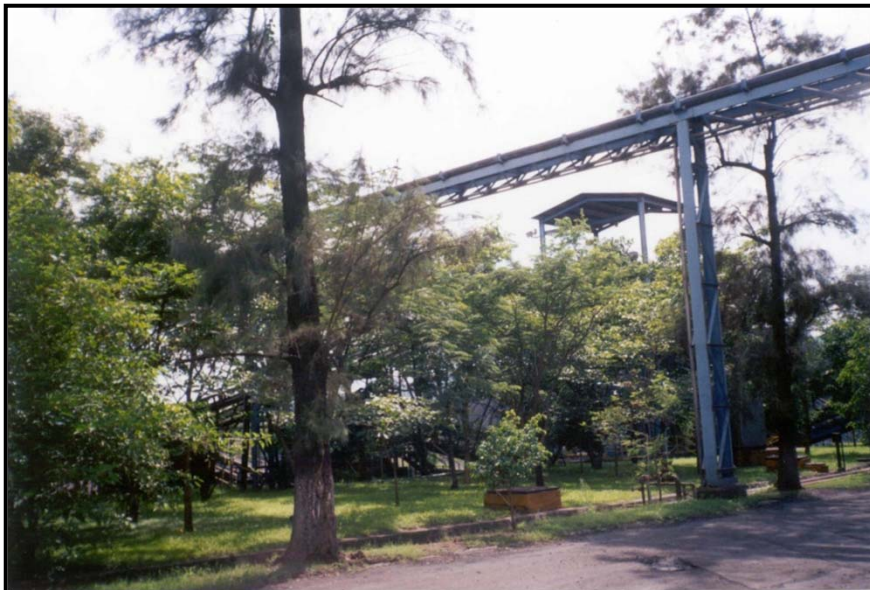
Banda transportadora dentro de la planta peletizadora de Estación Alzada, Mpio. de Cuauhtémoc, Col.
