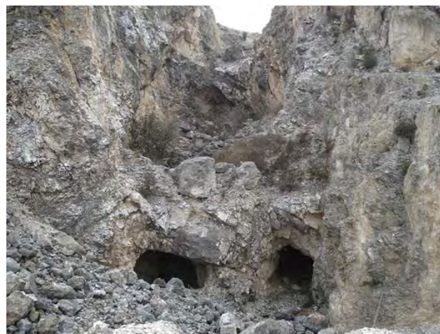
Minado a tajo abierto sobre cuerpos irregulares de calcita. Mina La Blanca región minera La Ascensión
