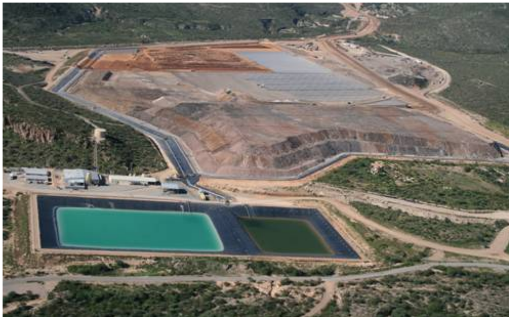
PROCESO DE LIXIVIACIÓN POR MONTONES DE MINERAL MINERA SAN XAVIER S.A. DE C.V.
