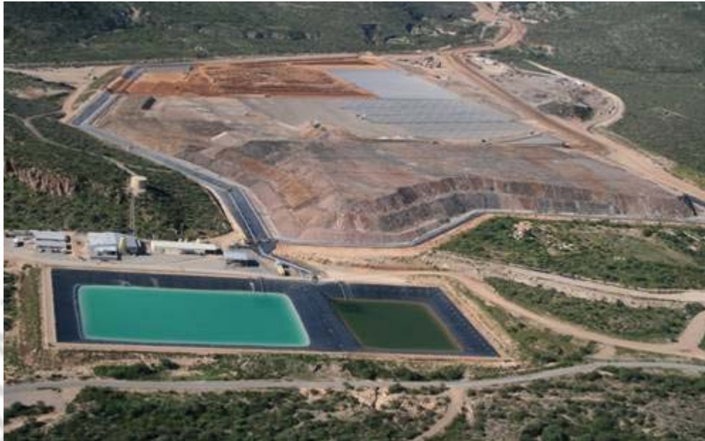
Proceso heap leaching Minera San Xavier S.A. de C.V., producción de mineral 32,000 t/d, movimiento de tepetate 30,000 t/día; Producción anual 100,000 onzas de oro, 2.5 millones de onzas de plata.
