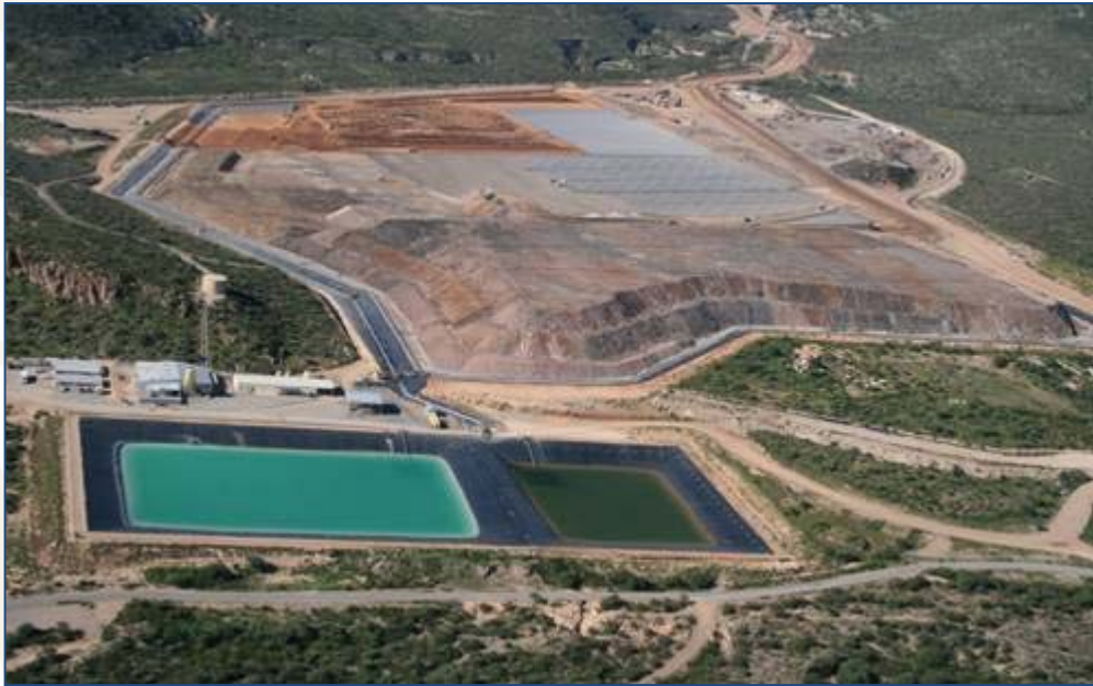
Proceso heap leaching (lixiviación en pilas). Minera San Xavier S.A. de C.V., producción de mineral 32.000 t/d, movimiento de tepetate 30.000 t/día; Producción anual 100.000 onzas de oro, 2.5 millones de onzas de plata.
