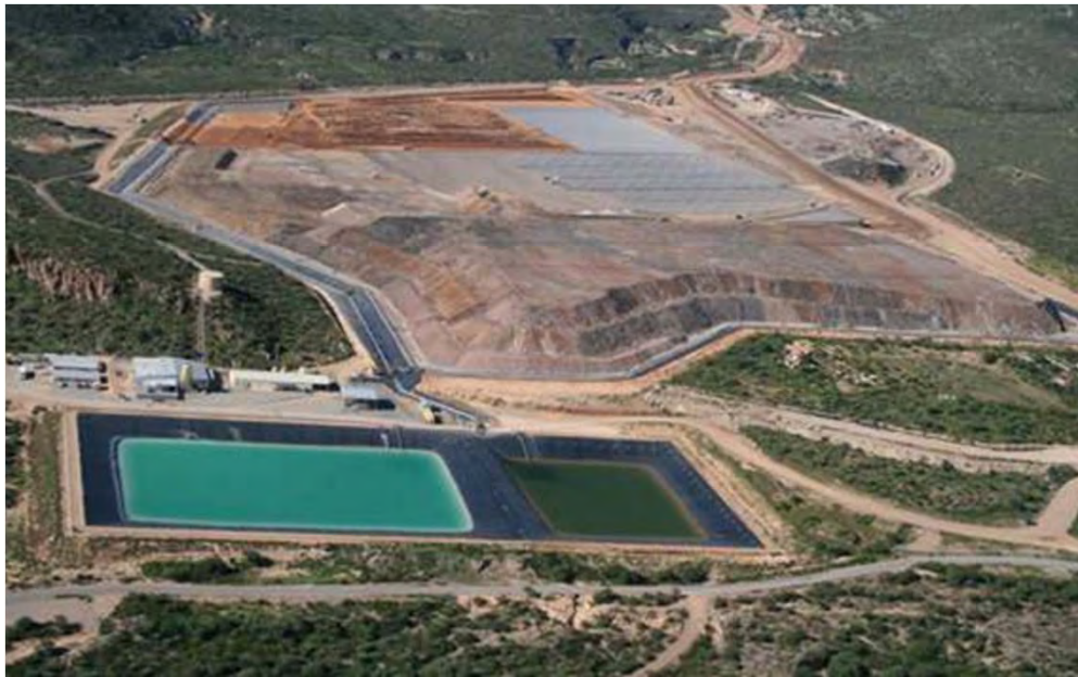
Proceso de Cianuración por montones Minera San Xavier S.A. de C.V., producción de mineral 32,000 t/día, movimiento de tepetate 30,000 t/día, Producción anual 100,000 onzas de oro, 2.5 millones de onzas de plata.
