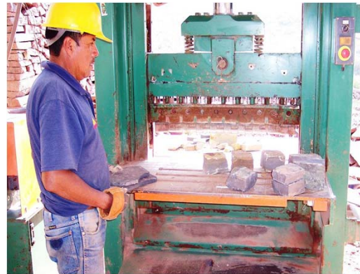
Corte de bloques para la construcción municipio de Tanquián
