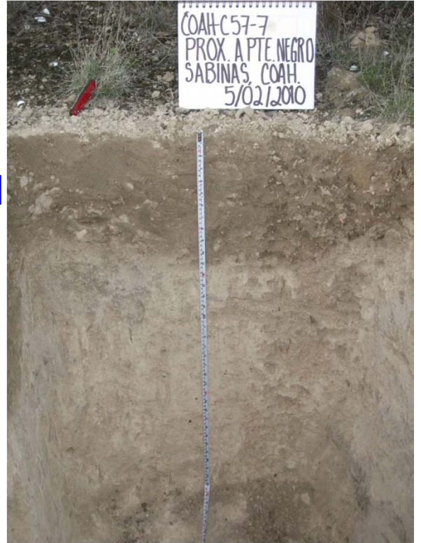
Toma de muestras en los diferentes capas del suelo en el proyecto contenidos Geoquímicos del Relieve Mexicano.
