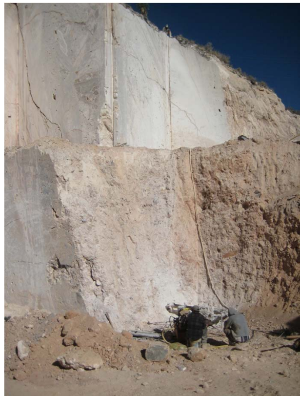
Maquina barrenando, para luego introducir el hilo diamantado para el corte del bloque.
