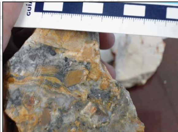
Detalle de brecha hidrotermal totalmente reemplazado por cuarzo calcedónico bandeado, muestras VMF17 A- D
