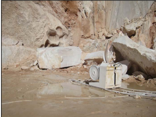
Cortadora de hilo diamantado realizando un corte de un bloque.
