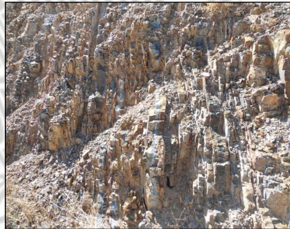
Secuencia sedimentaria de caliza, arenisca y lutita con intensa alteración hidrotermal argílica e oxidación y silicificación, muestras VMF11C y D
