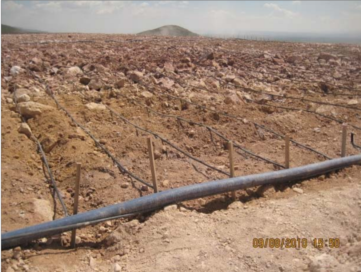
Camas de lixiviación, de donde sale la solución rica con valores de Oro y Plata
