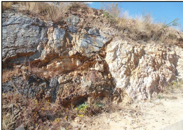
Contacto de secuencia sedimentaria de caliza arenisca y lutita intensamente alterada intuida por cuerpo de pórfido riolítico generando procesos hidrotermales con alteración argílica e intensa oxidación y silicificación. Muestras VMF11A-B.
