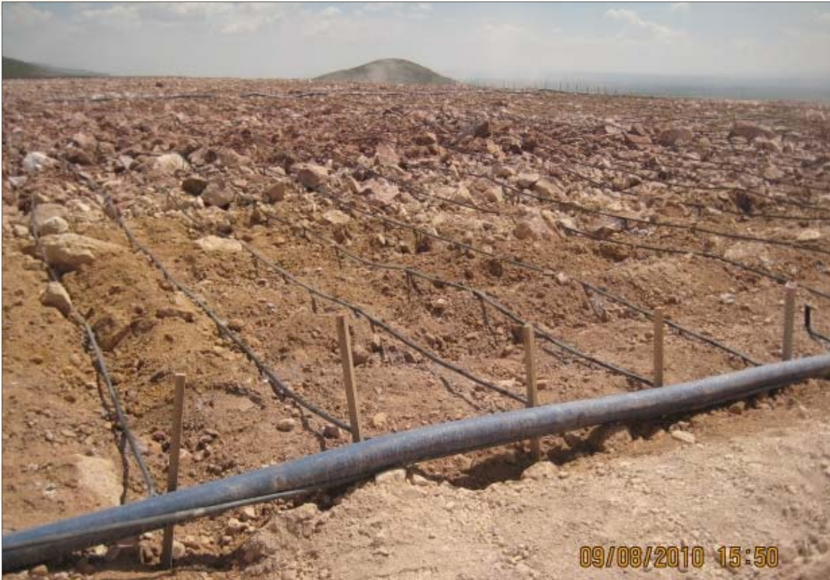
Camas de lixiviación, de donde sale la solución rica con valores de Oro y Plata
