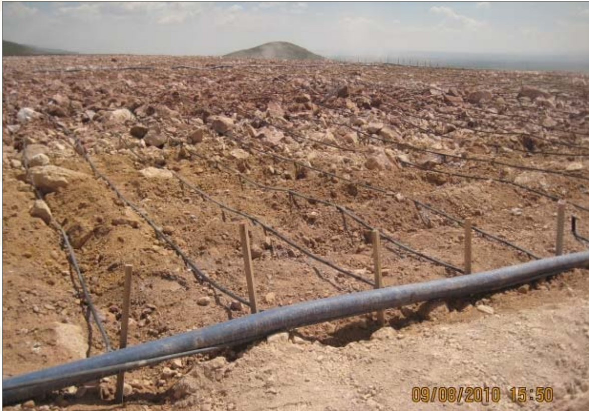
Camas de lixiviación, de donde se rocía con cianuro para obtener solución rica con valores de Oro y Plata
