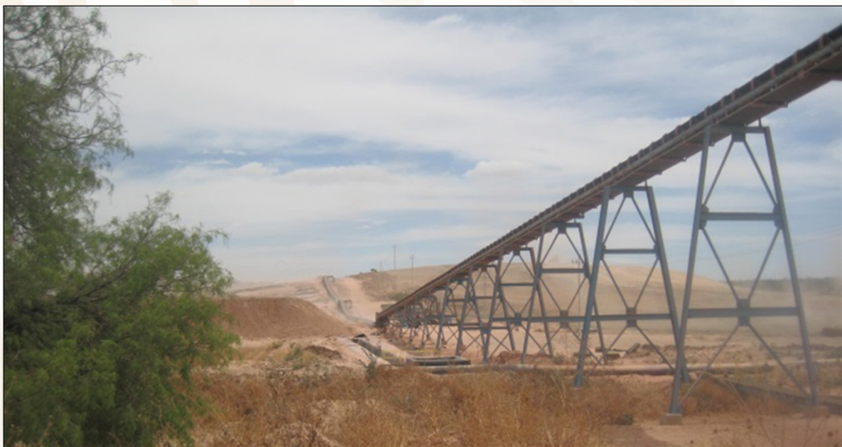
Bandas Transportadoras de material de mina del tajo a las camas de lixiviación.
