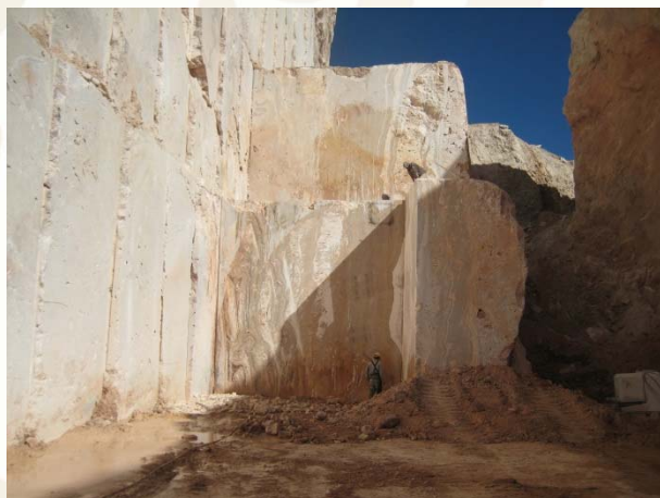
Detalle de los cortes de bloques de ónix sobre la veta.
