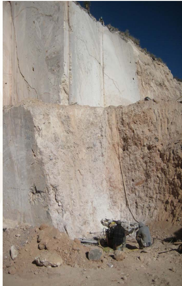
Máquina barrenando, para introducir el hilo diamantado para el corte del bloque.
