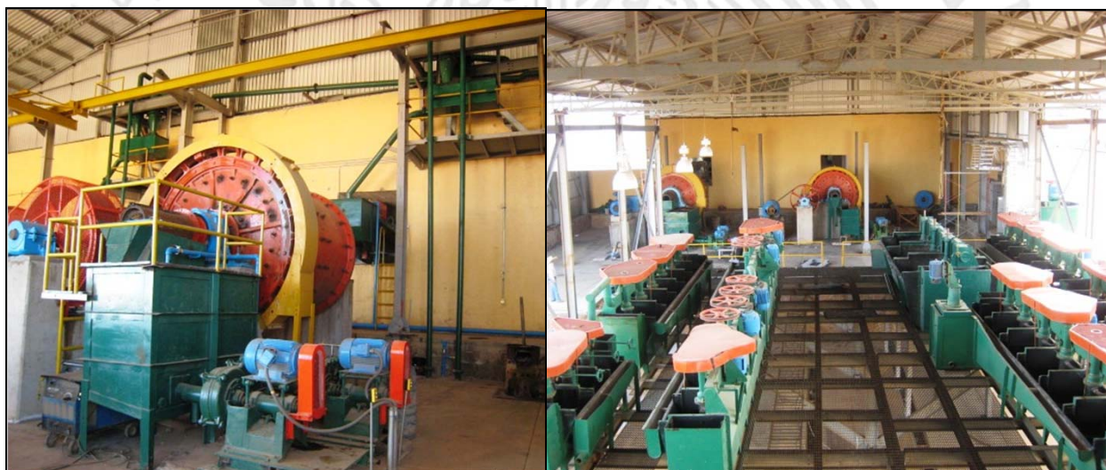
Molino 8 X 9 Pies, Caja de Succión y Bombas SRL -C 5 X 4"
