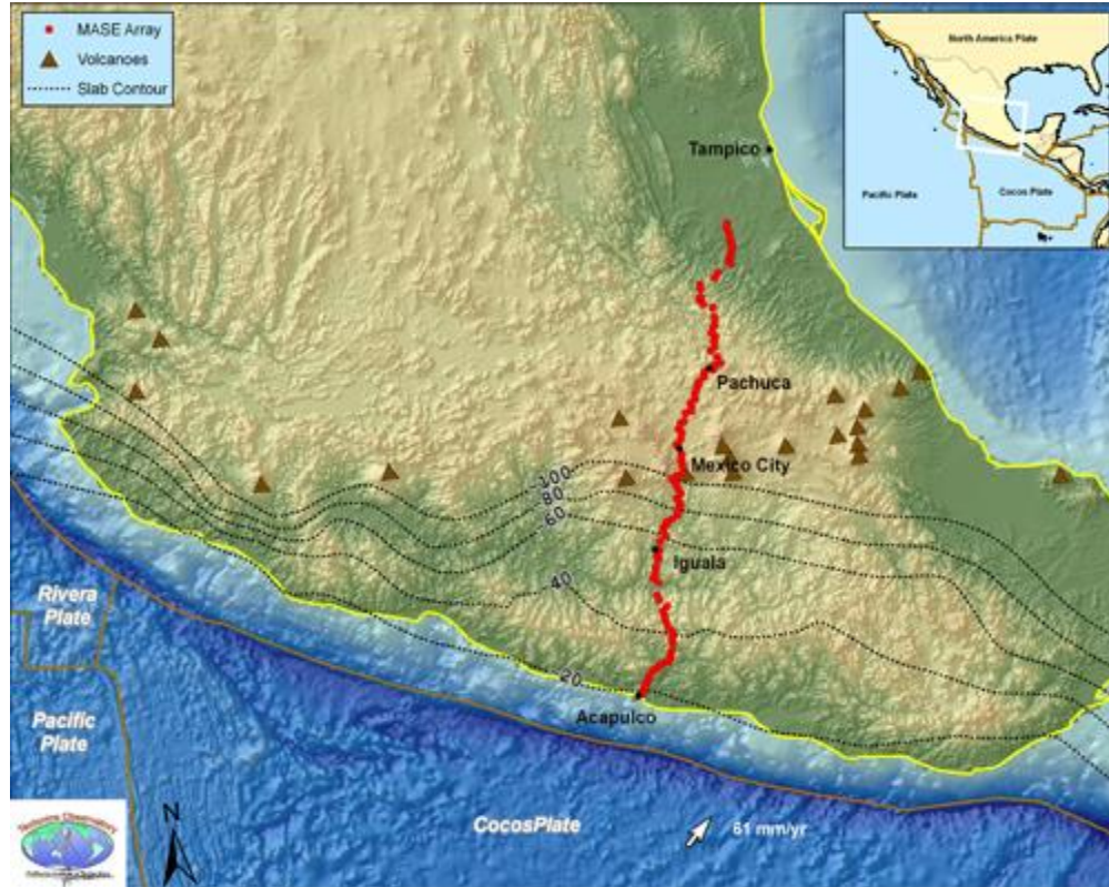
Figura 3. Línea densa de 100 sismógrafos de banda ancha denominada matriz MASE (MesoAmerican Subduction Experiment). Esta matriz (puntos rojos), con sismógrafos espaciados a 5 km de distancia, cruza México. Fue instalado en 2005. Las líneas de contorno muestran la profundidad de la placa de subducción. [Modificado de Chen y Clayton, JGR 2009].
